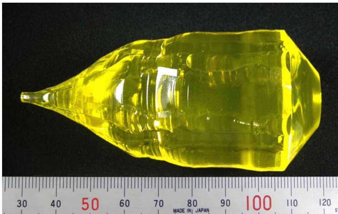
図1: YAG 単結晶蛍光体インゴット
